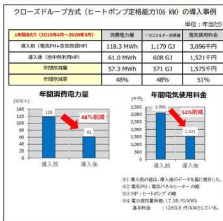
図-11. 空気熱源ヒートポンプとクローズドループ方式のランニングコストの比較
